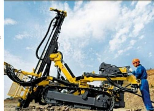
Верхний вращатель имеет большой запас прочности, а применение ППУ позволяет не терять силу удара при увеличении глубины, так как удар происходит в самой нижней точке скважины, а не передаётся через весь став. Эта особенность позволяет снять лишнюю нагрузку с буровых труб и обеспечить более прямолинейное бурение отверстий.
